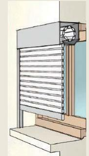
sous linteau enroulement intérieur
